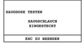
Um den Betrieb der elektrischen Anlage der Saugsteckdosen, den Schlauch bei jeglicher Saugsteckdose einstecken und wegnehmen, wobei es kontrolliert werden muss, ob die Anzeige auf dem Computer ändert.
