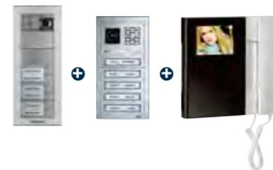
**B-fast** rappresenta la massima espressione di tecnologia di Bitron Video. L'utilizzo di **B-fast** permette l'installazione di impianti video particolarmente evoluti con solo due conduttori, non polarizzati, in tutto l'impianto. Sono inoltre inclusi nelle prestazioni standard di **B-fast** la telecamera a colori in pulsantiera, il servizio intercomunicante, la possibilità di aggiungere un moderno sistema di video sorveglianza e tutto questo senza aggiungere conduttori all'impianto.
