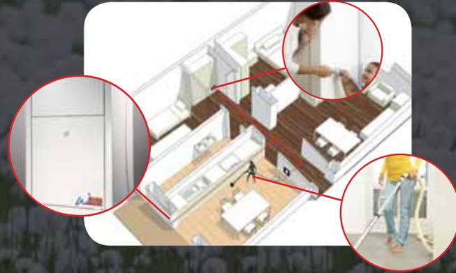
L'aspirapolvere centralizzato, con Wolly 2, è diventato un sistema ancora più semplice da installare: con poche ore di lavoro si realizza la rete tubiera e la sede per la centrale aspirante. Il completamento potrà essere fatto a cantiere ultimato, e grazie al coperchio paramalta fornito, l'integrità estetica della centrale viene mantenuta.
