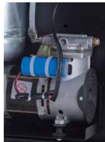
Dettaglio del compressore
